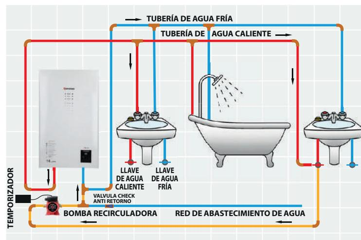
En este modo la bomba está conectada abajo del calentador a una tubería adicional de retorno.
