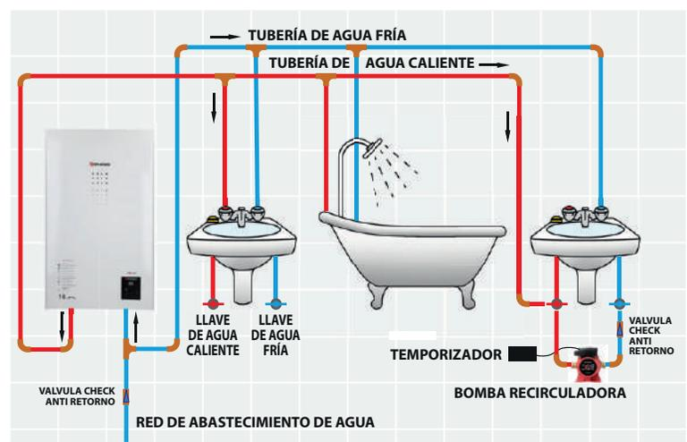
En este modo la bomba se instala bajo del último punto de consumo de agua, en conexión con la cañería de agua fría.
